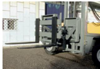
Exakt auf die Lasten abgestimmte Anbaugeräte werden von BAUMANN Großteils selbst gefertigt. Integriert in den Gabelträger werden diese ohne Tragkraft- bzw. Nutzbreitenverlust angeboten.
