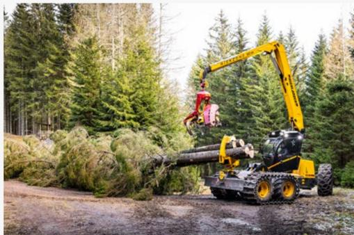
**Ein Quantensprung in Mobilität und Flexibilität: Der Highlander versteht sich als äußerst leistungsstarker Radharvester für mittleres bis starkes Holz**
