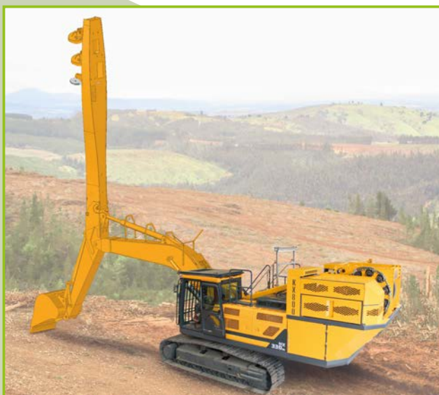
SEILROLLEN MIT GROSSEM DURCHMESSER
