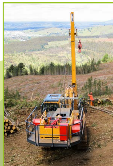
SCHNELLE MONTAGE DES MASTS
