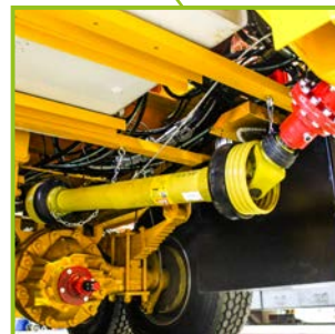
ZUSÄTZLICHER ACHSANTRIEB (optional)
