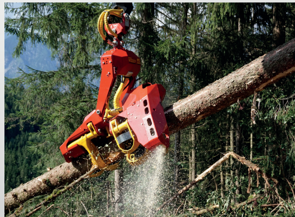
Der Woody verfügt über eine hohe Baulänge, die ein kontrolliertes Fällen starker Bäume ermöglicht.
